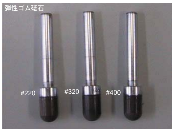
図-5 (株)メイホー製弾性ゴム砥石(シャンク径: 6 mm)
