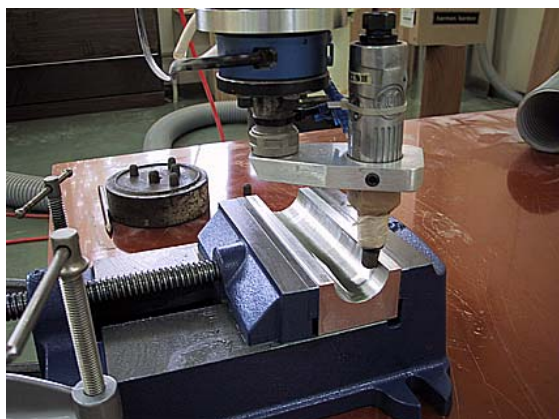
図-3 エア駆動式の砥石工具の接続部
