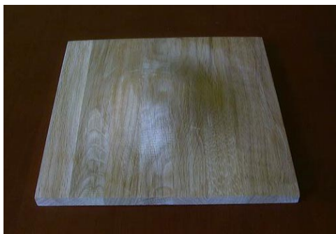
図-9 オービタルサンダーで木地仕上げされた木製ワーク
