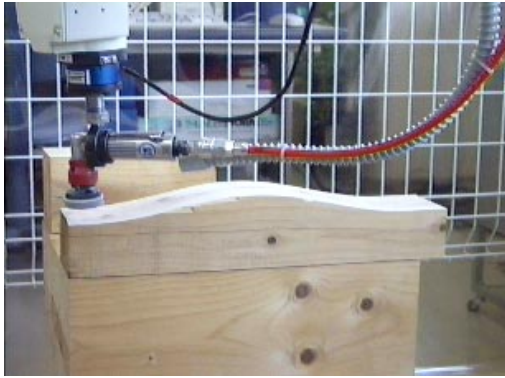
図-7 回転式研磨工具を用いた研磨実験風景
