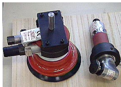
図-6 振動式の研磨工具
