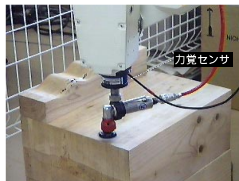
図-5 回転式の研磨工具
