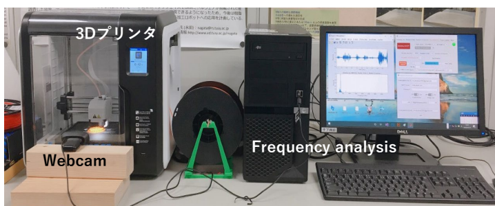
図 1 3D プリンタ積層加工時の周波数解析による監視風景
